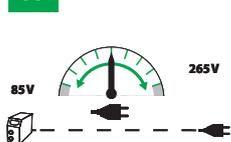
Устройство работает от простой розетки 230В-16А или 110В-32А даже при интенсивном использовании и на внутренних участках (100 м).
